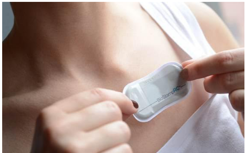
図1: ウェアラブル医療機器は、絆創膏ほどのサイズに進化しながら、多くの知能とメモリーを組み込んでいる。このような機器は、3Dリジッドフレキシブル基板をかなり使用している。写真提供 MC10, Inc.
