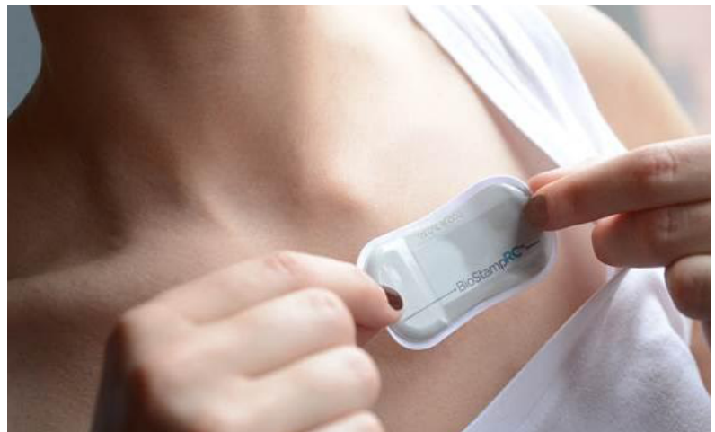
Figure 1: les dispositifs médicaux portables ont évolué et il n'est plus seulement question de tailles de pansements : ils intègrent désormais d'immenses capacités d'intelligence et de mémoire. Des dispositifs comme celui-ci utilisent une quantité considérable de circuits imprimés flex-rigides en 3D. Crédit photo: MC10, Inc.
