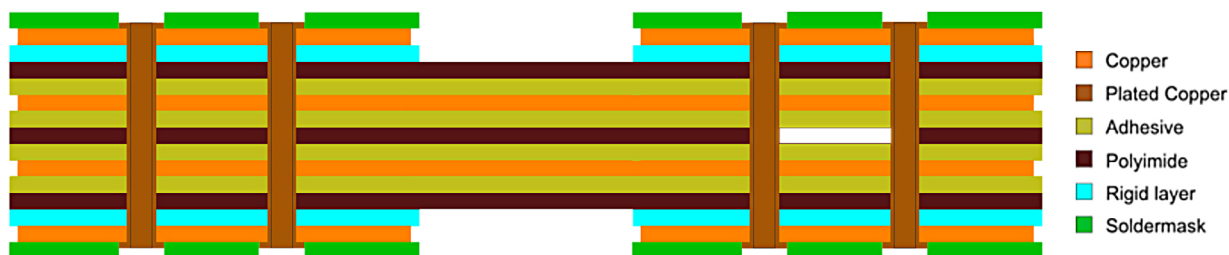
Figure 4: le logiciel de conception de circuits imprimés permet de travailler sur l'assemblage dans son intégralité. Ici, les circuits imprimés rigides sont placés à chaque extrémité et reliés par un circuit flexible à double couche.
