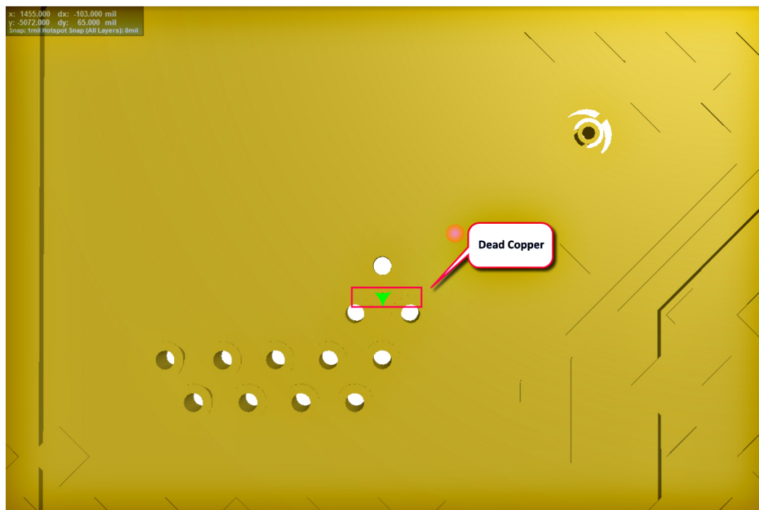
Abbildung 10: Im 3D-Modus konnte der Designer das nicht verbundene Kupfer finden und eine Füllung platzieren.
