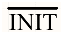
Invertierte Signale in Altium Designer (Möglichkeit 1)
