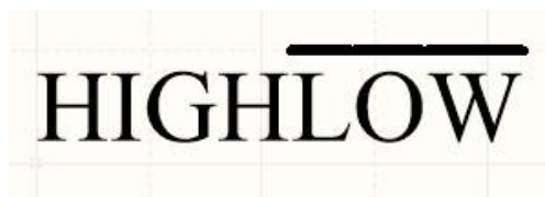
Invertierte Signale in Altium Designer (Möglichkeit 2)
