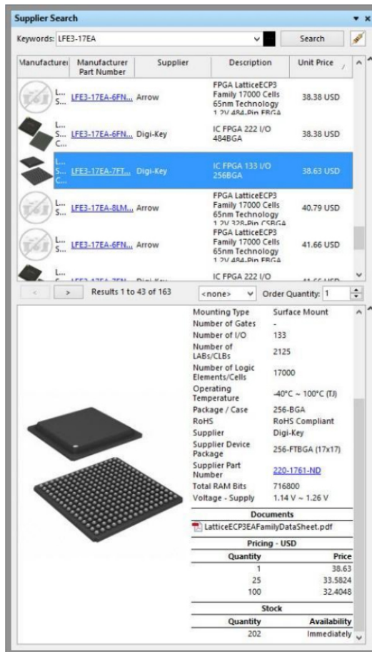
図3: Supplier Searchパネルを使用すると特定のコンポーネントを検索可能。
