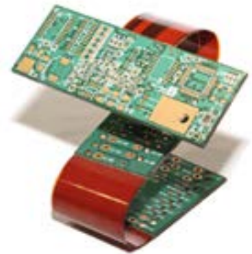
Abbildung 2: Üblicherweise werden beim Rigid-Flex-Design die Bauteile auf den starren Teilen der Leiterplatte verbaut, die dann mit flexiblen Teilen verbunden werden. Die flexiblen Teile der Leiterplatte ermöglichen eine Biegung der Baugruppe, um sie in das
